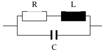
$$Z(\omega, R, L, C) := \frac{Z1(\omega, R, L) \cdot Z2(\omega, C)}{Z1(\omega, R, L) + Z2(\omega, C)} \quad \text{Definition des Gesamtwiderstandes}$$
