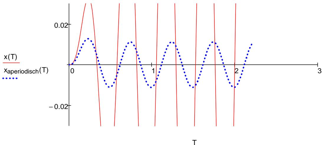
Die Animation liefert für einen exemplarischen Wert der Erregerfrequenz (hier voreingestellt  $f=2\text{Hz}$ ) die Ergebnisse für unterschiedliche Dämpfungskonstante  $b$ . Man sieht schön den Einfluß auf Amplitude und Phasenlage
