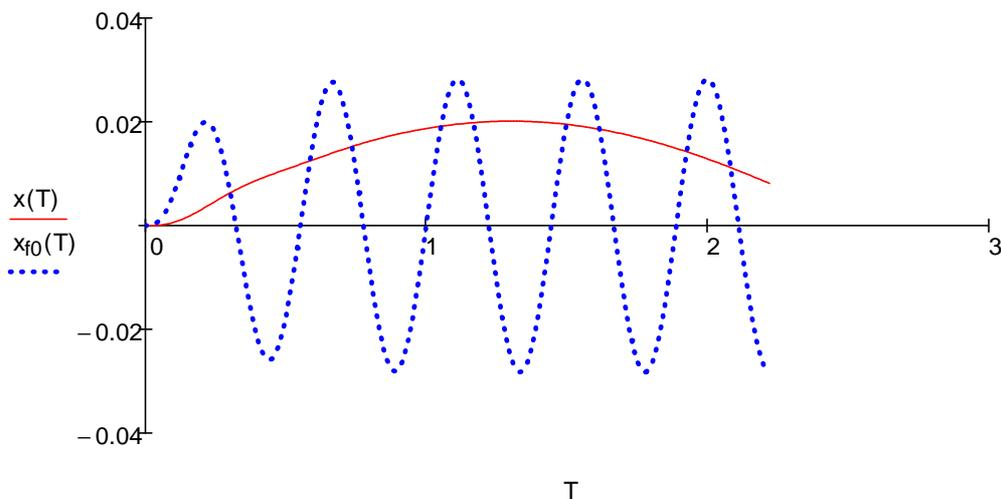
Die Animation liefert für einen exemplarischen Wert der Dämpfung (hier voreingestellt  $b = 3000$  kg/s) die Ergebnisse für unterschiedliche Erregerfrequenzen  $f$ . Man sieht schön den Einfluß auf Amplitude und Phasenlage (speziell im Vergleich mit der Lösungskurve für den Fall  $f = f_0$ )
