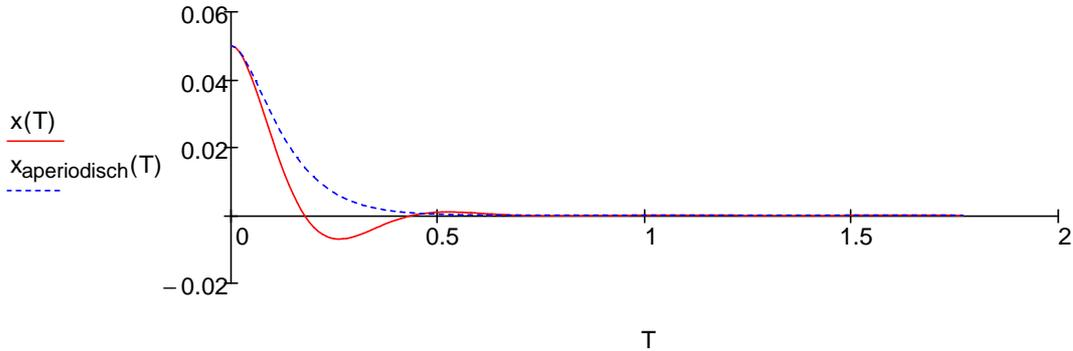
Es erfolgt wieder ein Vergleich mit dem aperiodischen Grenzfall. Der "Techniker" orientiert sich bei der Konstruktion von Federn (z.B. bei der Dämpfung eines Drehspulinstrumentes) manchmal gerne am Fall der "ganz leichten Schwingung" statt dem aperiodischen Grenzfall, weil der Übergang in den "Ruhezustand" zwar (kaum merklich) schwingend, aber schneller erfolgt als im aperiodischen Grenzfall. Dies sieht man gut, wenn man oben beispielsweise  $b=7000$  kg/s setzt.
