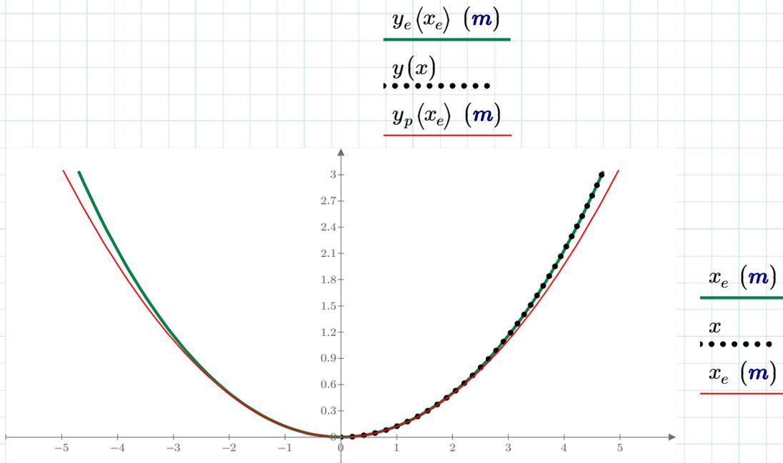
Die Kettenlinie wird im Diagramm im Bereich -5 m bis 5 m dargestellt (die numerische Lösung nur in einer Hälfte). Durch den großen Durchhang ist der Unterschied zur Parabel (rote Linie) auffällig. Die Kraft H beschreibt die (Zug)-Spannung im Seil. Wird H vergrößert, so verringert sich daher der Durchhang und der Unterschied zur Parabel wird geringer.
