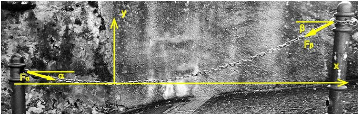
Der Verlauf der Kette ( $\rho_k := 0.05 \text{ kg/cm}$ ) kann exakt durch  $y_{ke}(x) := 250 \cdot (\cosh(0.004 \cdot x) - 1)$  mit  $x := -50, -49 \dots 130$  beschrieben werden. ( $x, y \dots$  Koordinaten in cm)
