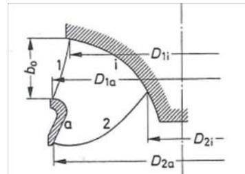
Bild 1.7 Hydraulisches Profil des Francislauftrades
