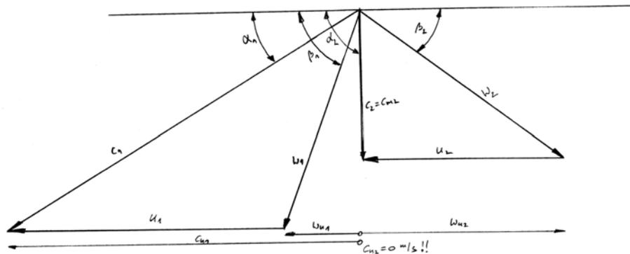
Durch Anwendung der trigonometrischen Grundfunktionen Sinus, Cosinus und Tangens lassen sich die Bestimmungsgrößen der Dreiecke berechnen.
