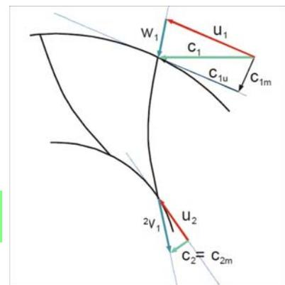
Mit den Relativgeschwindigkeiten (bzw. deren Winkeln) kann das Lauftrad im Meridianschnitt konstruiert werden.
