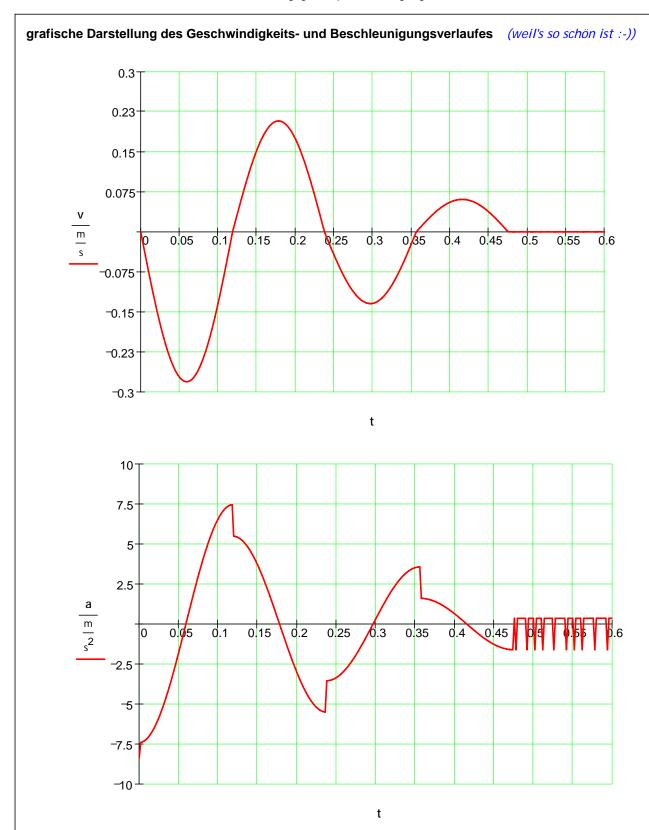
Die Sprünge nach jeder Halbschwingung rühren daher, dass der Beschleunigungsanteil von  $F_R$  /  $m_S$  durch den Richtungswechsel schlagartig das Vorzeichen wechselt.
